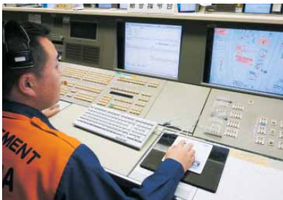
▲位置情報通知システムの運用開始(2月) 携帯電話やIP電話などから119番通報された発信位置をコンピューター画面の地図上に表示する位置情報通知システムの運用を開始しました。
